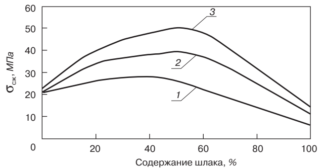
Рис. 2. Зависимость прочности при сжатии образцов керамических материалов на основе смеси глин Михайловского и Железногорского месторождений от содержания шлака и температуры обжига: 1 – 1000°C; 2 – 1050°C; 3 – 1100°C
