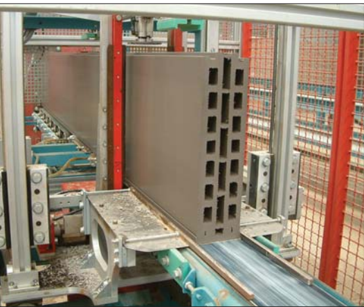
Автомат резки для фасадной плитки
