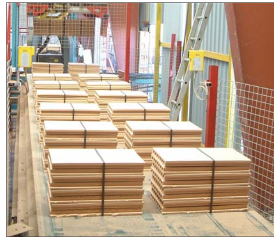
Связанная в пачки фасадная плитка
