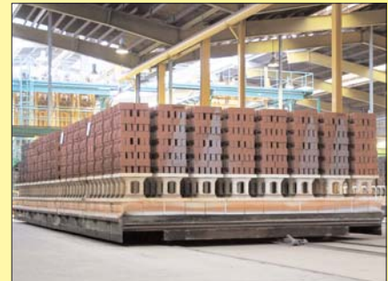
Фирма Röben, Querenstede, Германия. Печь фирмы Lingl, на туннельных вагонетках применен материал BurcoLight
