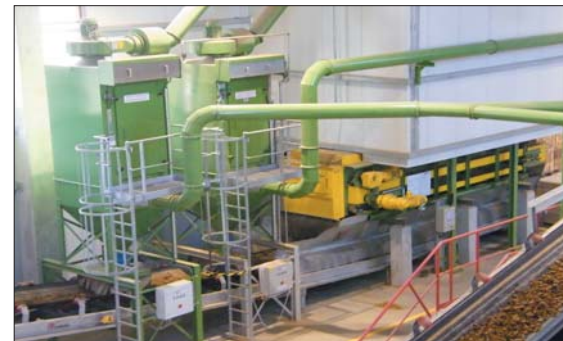
Ящичный питатель для сырьевого материала с двумя пылеуловительными устройствами пропускной способностью 5000 м³/ч
