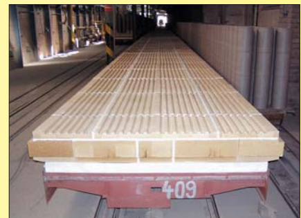
Фирма Schiedel, Цлив, Чехия. На туннельных вагонетках для обжига канализационных труб применен материал BurcoLight
