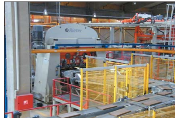
Револьверный пресс для производства черепицы DR 6 – 24000 для 4 заготовок с гидравлическим подъемным устройством. Система подачи кусков глиняного бруса с распределительным устройством, накопителем и питающими транспортерами
