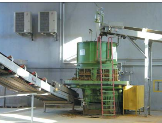
Барабанный сетчатый питатель SBM 1900 – первая ступень массоподготовки
