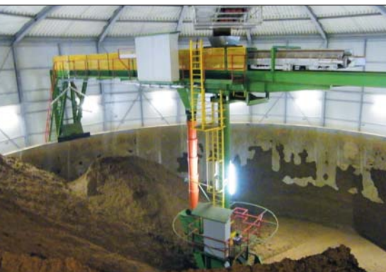
Круглый шихтозапасник с поворотным питающим транспортером
