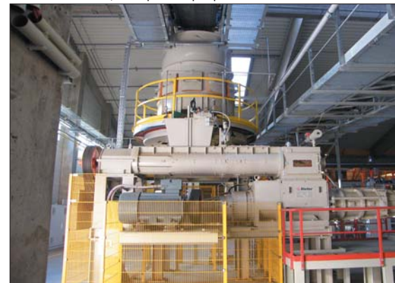
Барабанный сетчатый питатель SR 1900 S и вакуумный агрегат SP 560/500 – VDWM 2308. Устройство для резки глиняного бруса
