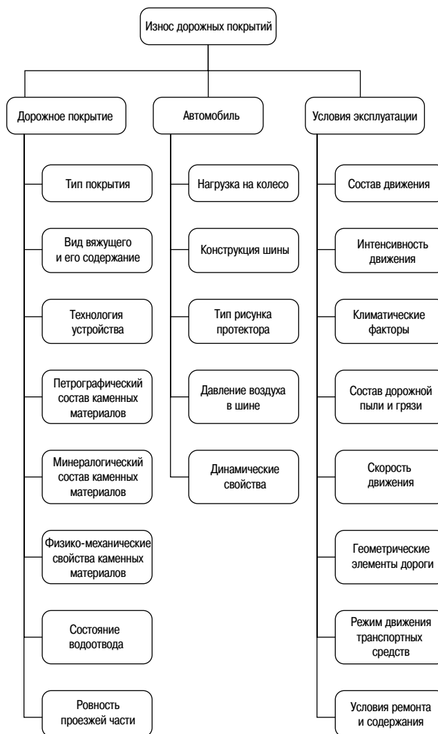
Рис. 2. Факторы, влияющие на износ дорожных покрытий
