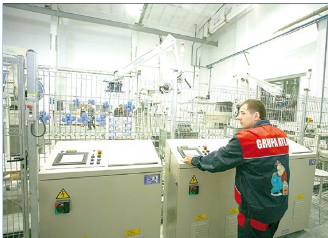
Упаковка всей продукции производится на одной роботизированной линии с автоматической пленочной упаковкой, которая обслуживается компьютерной системой
