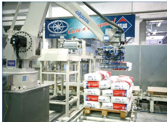
Один из трех промышленных роботов OKURA, работающих на линии упаковки. Это оборудование не часто можно встретить на заводах по производству сухих смесей
