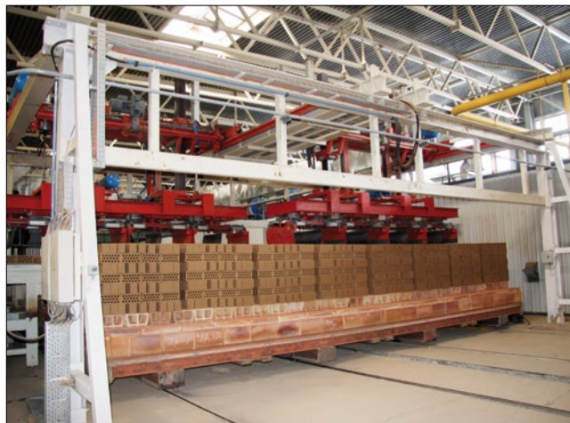
Автомат-садчик печной вагонетки с 8 захватными устройствами
