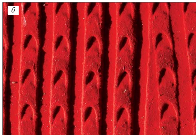
Рис. 1. Противоскользящее покрытие с посыпкой: а) зеленой крошкой фракции 1–1,6 мм; б) красной крошкой фракции 2–3 мм
