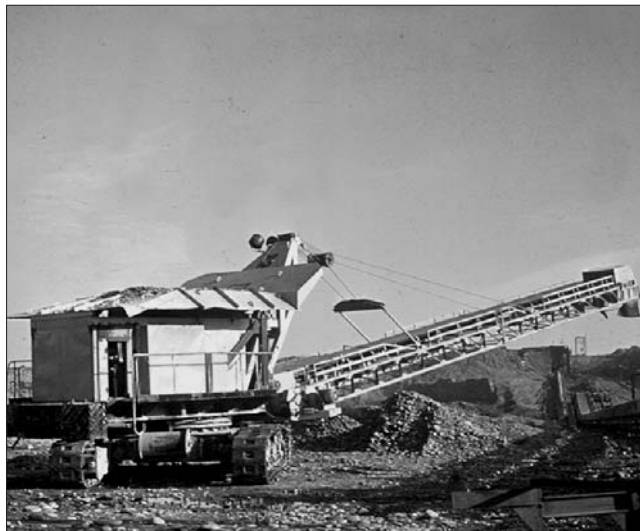
Бункер-питатель конструкции ВНИПИИстромсырье, выпущенный Волгоцеммашем, испытывается на Дагестанском карьероуправлении (1985 г.)
