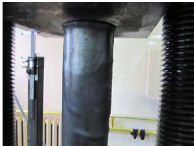
Рис. 6. Характер разрушения моделей ТБК при относительной деформации 0,05
