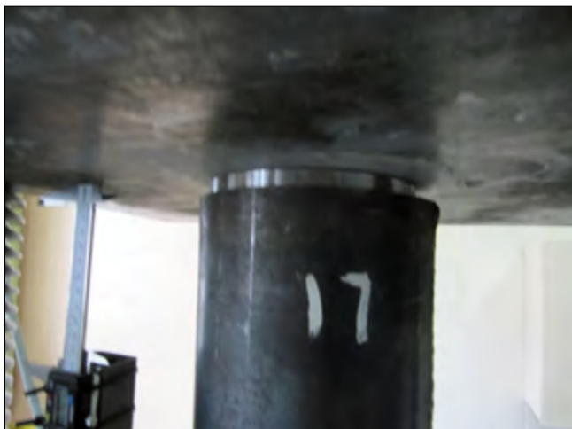
Рис. 1. Круглые ТБК 2 под действием нагрузки
