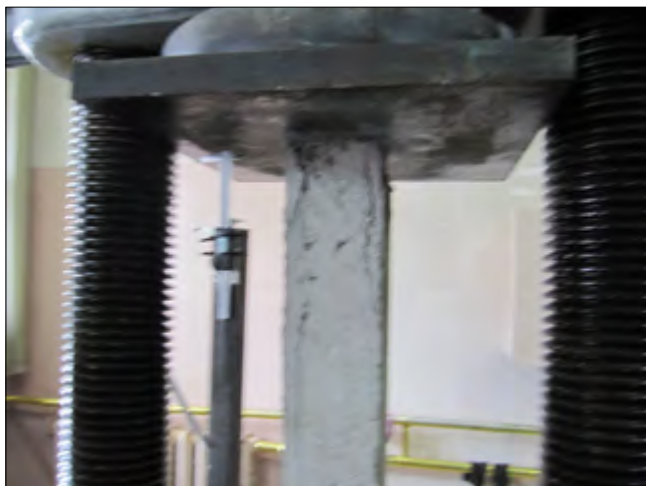
Рис. 5. Характер разрушения моделей обычных колонн при относительной деформации 0,005
