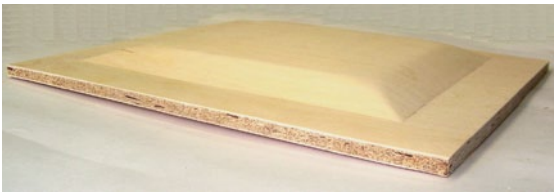
Рис. 1. Дверная филенка с внутренними слоями из мелких древесных отходов, наружными слоями из лущеного шпона
