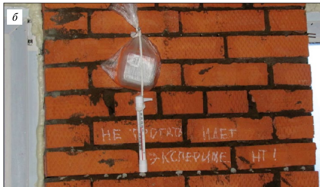
Рис. 1. Хранение образцов раствора: а – в наружных (холодных) условиях; б – в утепленном объеме с контролем влажности и температуры
