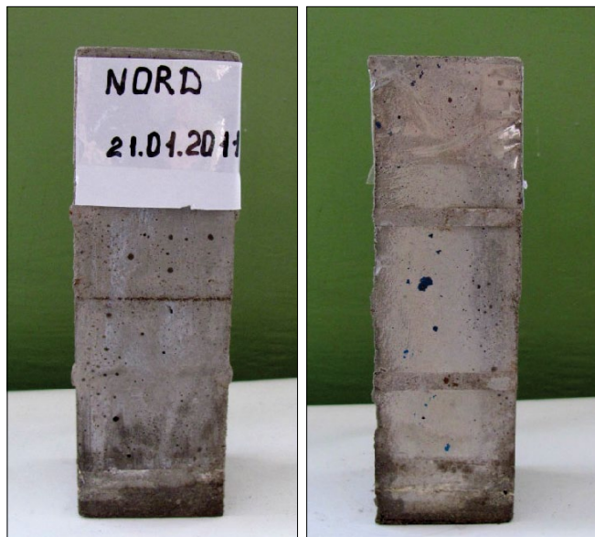
Рис. 6. Отсутствие следов высолообразования на образцах раствора с противоморозной добавкой NORD-Полипласт
