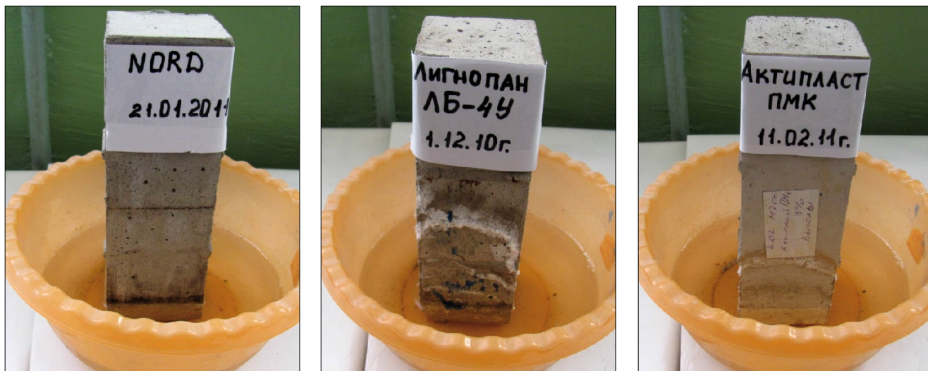
Рис. 3. Методика тестирования образцов на высолообразование
