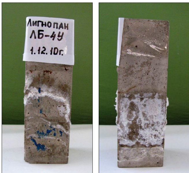
Рис. 4. Высолообразование на образцах раствора с противоморозной добавкой Лигнопан ЛБ-4У
