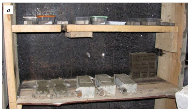
Рис. 1. Хранение образцов раствора: а – в наружных (холодных) условиях; б – в утепленном объеме с контролем влажности и температуры
