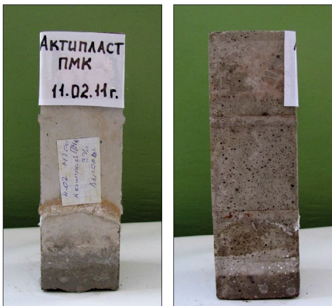
Рис. 5. Отсутствие следов высолообразования на образцах раствора с противоморозной добавкой Актипласт ПМК
