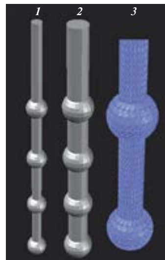
Рис. 2. Объемная модель сваи ЭРТ с уширениями (1), окружающего уплотненного грунта (2) и разбивка на конечные элементы (3) перед импортом в ПК Plaxis
