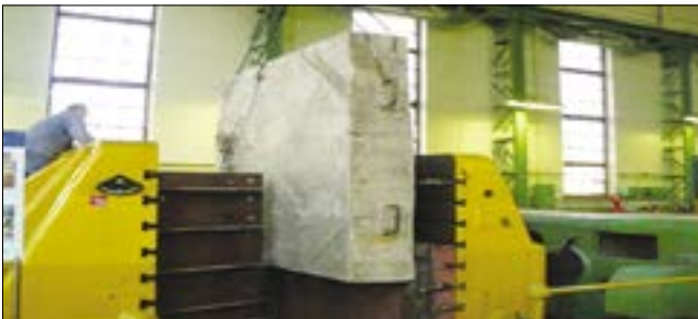
Рис. 2. Общий вид экспериментального образца в испытательной машине
