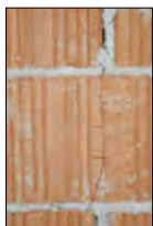
Рис. 8. Вертикаль- ные трещины во вну- треннем слое образца № 1 после огневого воздействия на сте- ну в течение 180 мин
