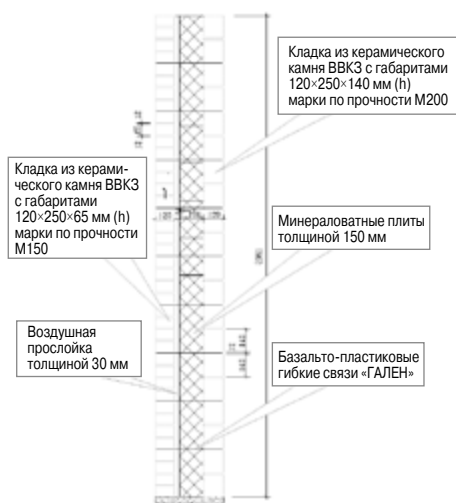
Рис. 1. Вертикальный разрез образца № 1
