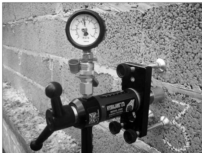
Рис. 1. Испытание анкера на объекте
