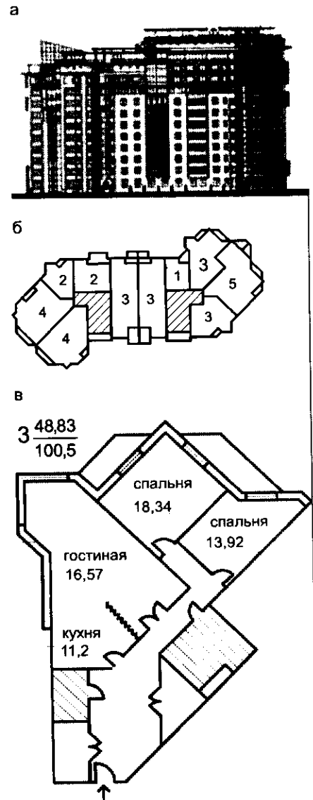
Рис. 1. Москва (ЮЗАО), ул. Минская, 1 а — общий вид; б — план типового этажа; в — план трехкомнатной квартиры
