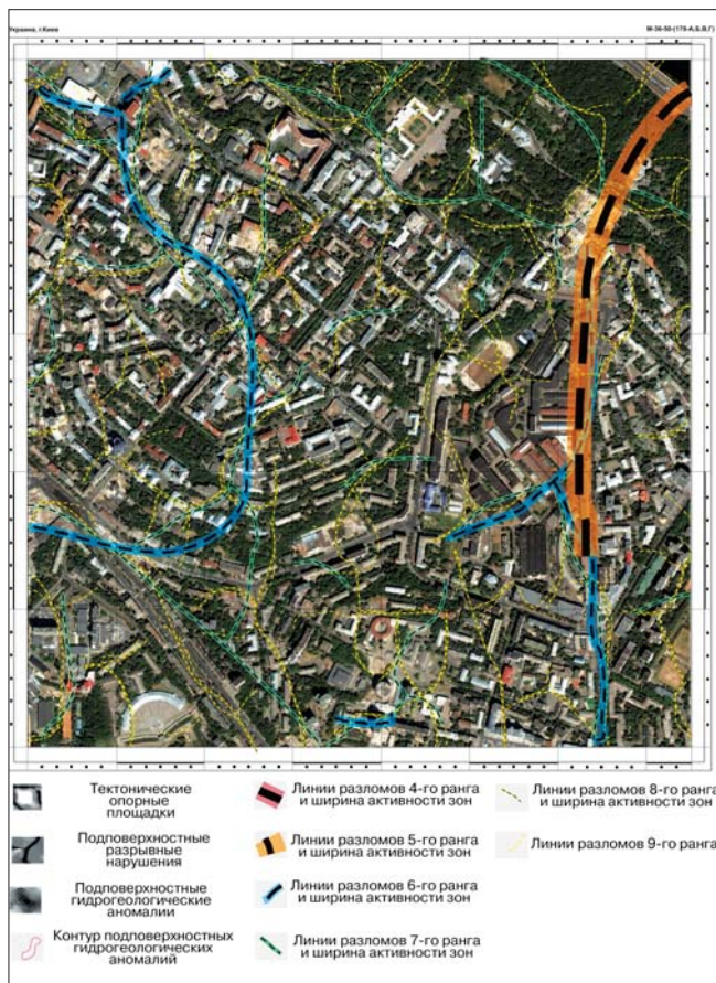
Рис. 6. Разрывные нарушения в приповерхностных слоях на территории центральной части города (фрагмент). Материалы космической и аэрофотосъемки территории с использованием тепловой технологии
