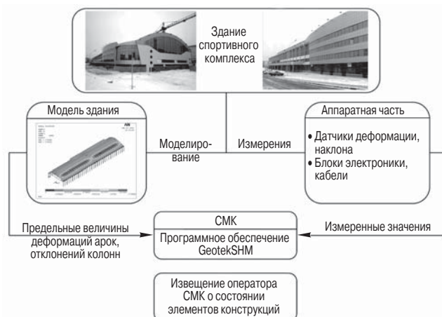
Рис. 2. Блок-схема взаимодействия аппаратной и расчетной частей системы мониторинга
