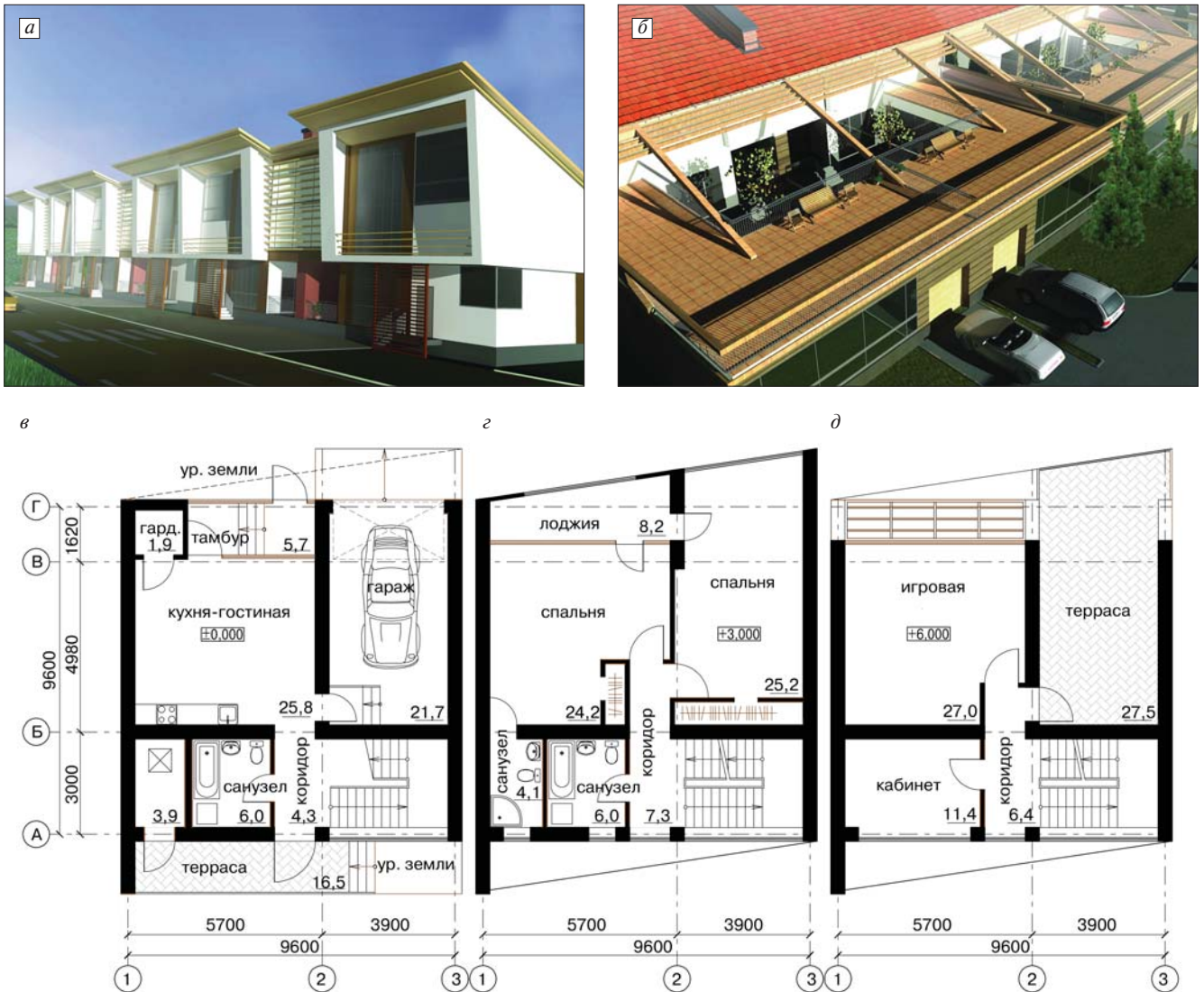
Рис. 2. Эскиз коттеджа люкс-класса: а – уличный фасад; б – дворовый фасад; в – план 1-го этажа; г – план 2-го этажа; д – план 3-го этажа
