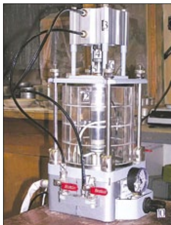
Рис. 1. Общий вид прибора трехосного сжатия стабилометрического типа
