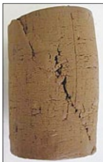
Рис. 10. Внешний вид образца после разрушения в условиях трехосного сжатия на приборе стабилометрического типа
