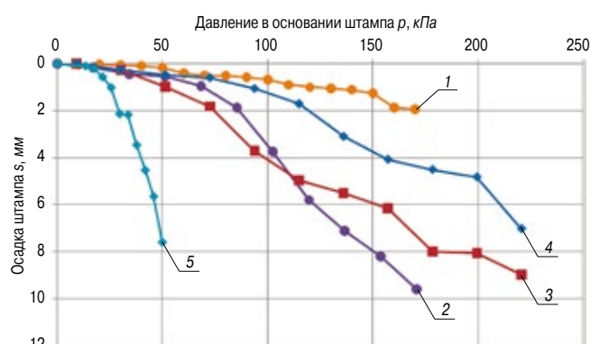
Рис. 5. Результаты испытаний укрепленного грунта штампом: 1 – схема № 1; 2 – схема № 2; 3 – схема № 3 (1); 4 – схема № 3 (2); 5 – схема № 4
