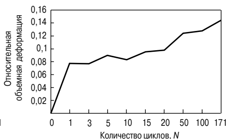
Рис. 5. Влияние числа циклов на изменение значений максимальных относительных объемных деформаций \varepsilon_v при циклическом испытании в стабилометре при величине бокового обжатия 100 кПа
