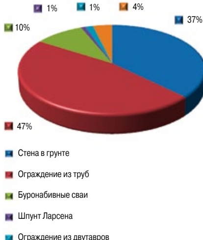
Рис. 2. Типы ограждения котлованов
