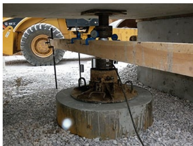
Рис. 7. Система нагружения основания
