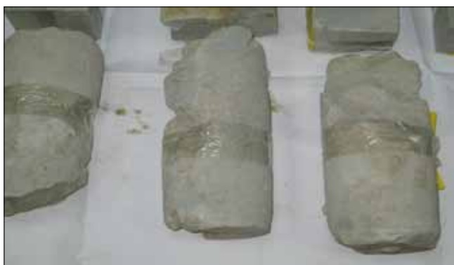
Рис. 7. Образцы грунта, закрепленного микроцементом
