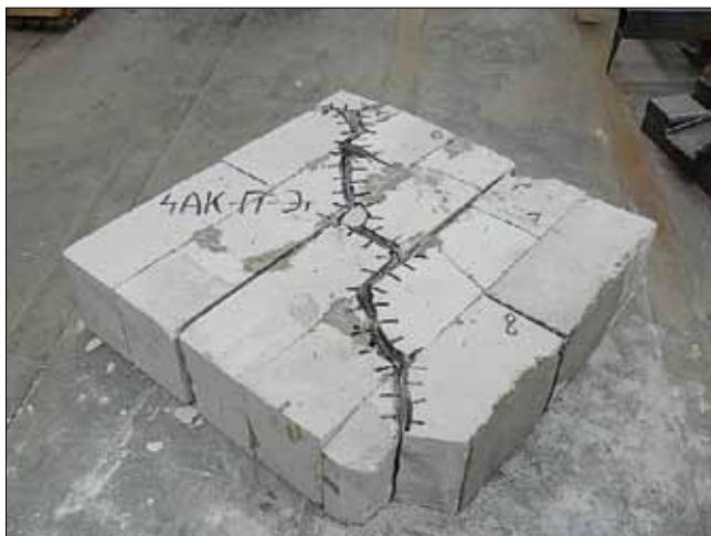
Рис. 3. Характер разрушения образцов после испытаний на перекос
