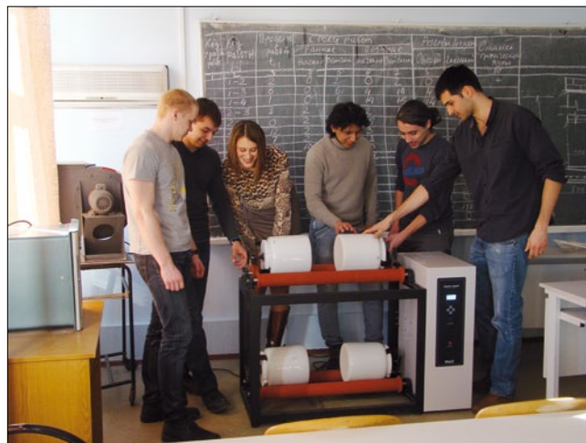
Рис. 2. Подготовка материалов в мельнице с электронным программным управлением для составления наноконструкции
