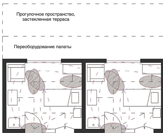
Рис. 7. Резервирование площадей для трансформирования палатного отделения
