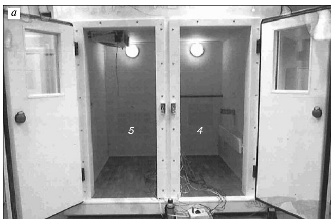
Рис. 4. Камера для теплофизических испытаний: а – внутренний вид; б – наружный вид; 1 – электросчетчик; 2 – вентилятор; 3 – микрометр; 4 – теплое отделение; 5 – холодное отделение
