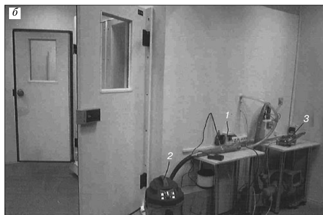
Рис. 4. Камера для теплофизических испытаний: а – внутренний вид; б – наружный вид; 1 – электросчетчик; 2 – вентилятор; 3 – микрометр; 4 – теплое отделение; 5 – холодное отделение
