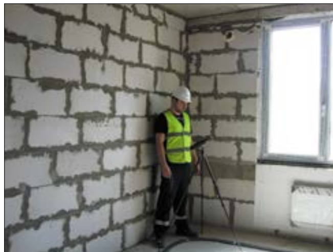
Рис. 2. Изоляция воздушного шума межквартирными стенами
