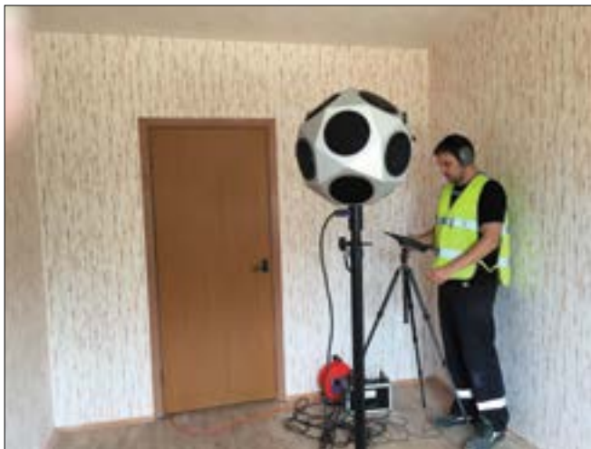
Рис. 3. Изоляция воздушного шума междуэтажными перекрытиями
