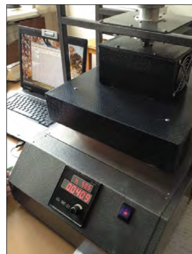
Рис. 4. Установка ПИТ-2.1 для измерения теплопроводности и термического сопротивления
