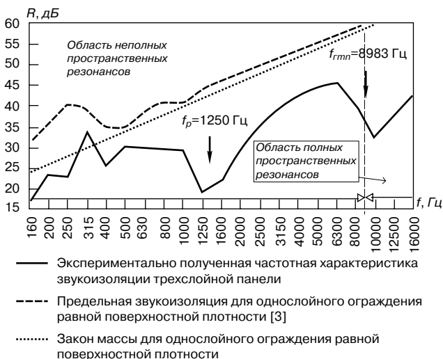
Рис. 4. Частотные характеристики звукоизоляции трехслойной панели размерами 1130 × 580 мм с облицовками из стальных листов толщиной по 1,3 мм и средним слоем из пенополистирола толщиной 30 мм
