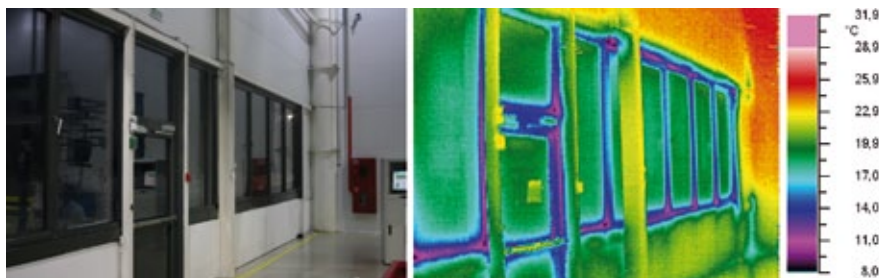
Рис. 1. Действительное и тепловое изображение элемента ограждающей конструкции
