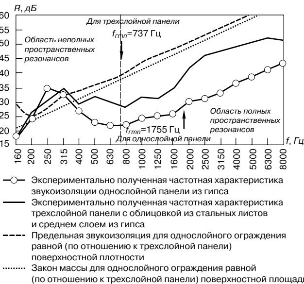
Рис. 5. Сравнение частотных характеристик звукоизоляции трехслойной панели с облицовками из стальных листов толщиной по 1,3 мм и средним слоем из гипса толщиной 22 мм и однослойной плиты из гипса толщиной 22 мм (размер образцов 1130 × 580 мм)
