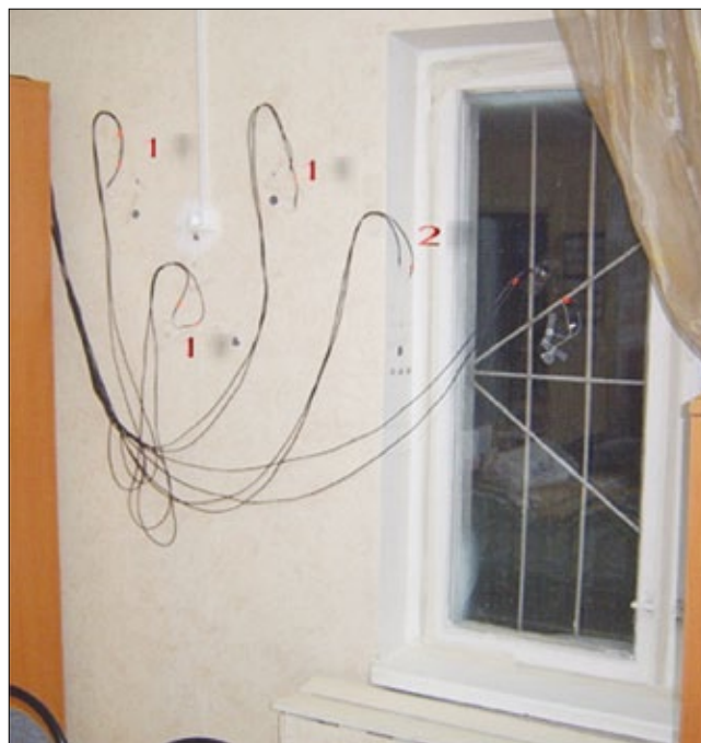
Рис. 1. Расположение датчиков температуры в помещении № 1
