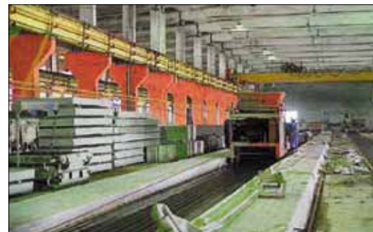
Линия по производству плит пустотного настила методом вибропрессования
