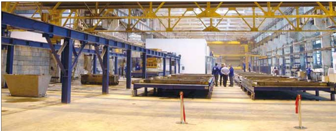
Современные полуроботизированные линии производства железобетонных изделий ОАО «Завод ЖБИ-6» позволяют быстро перенастроить оборудование под новый вид изделий и комплектовать нетиповые проекты без увеличения себестоимости
