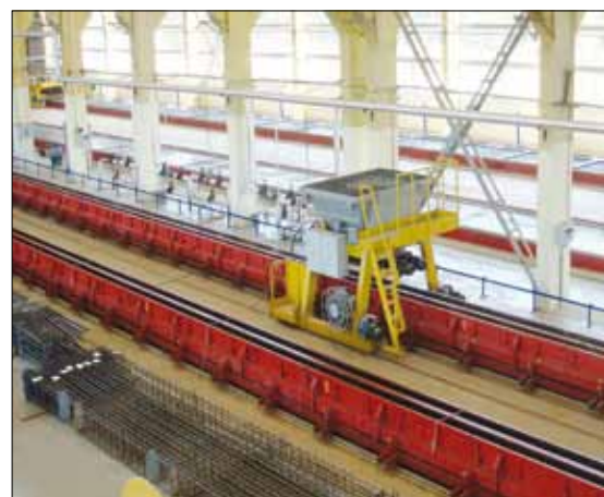
Технологические линии стендового производства элементов сборно-монолитного каркаса мощностью 90 тыс. м 2 каркаса в год. (г. Обнинск, Калужская обл.). Изготовлено ЗАО «Рекон»
