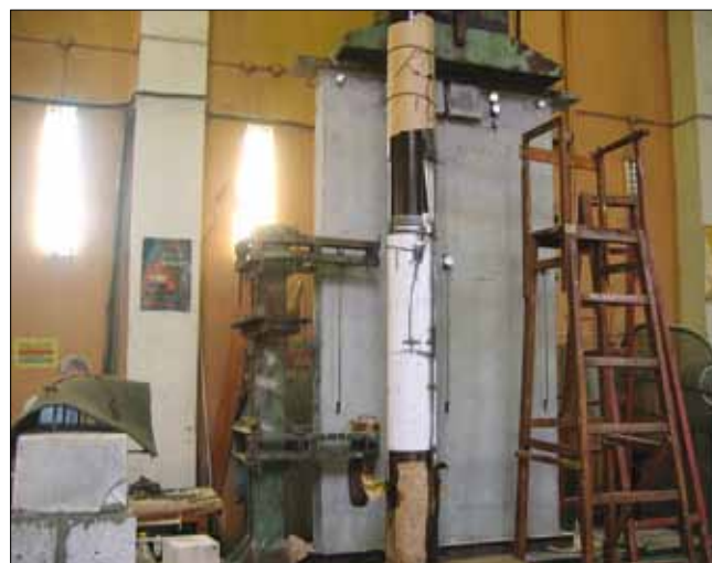
Рис. 3. Опытный образец фрагмента стеновой панели до испытаний
