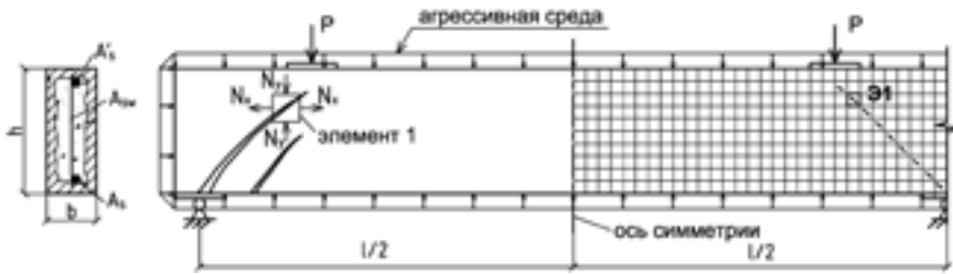
Рис. 1. Конечно-элементная модель двухпролетной железобетонной балки
