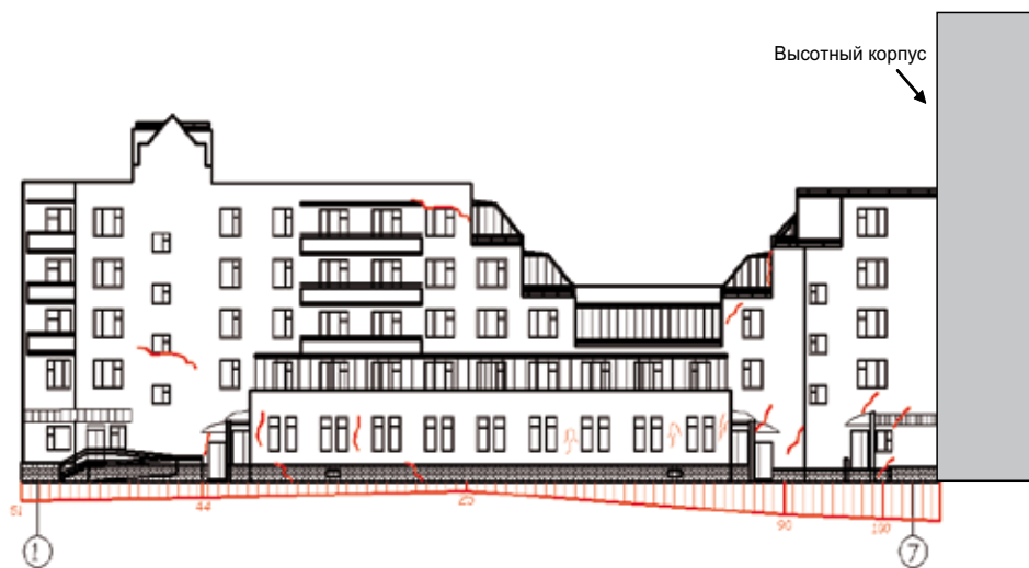
Рис. 2. Развитие осадок во времени по результатам геодезических наблюдений
