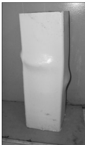
Рис. 1. Общий вид центрально-сжатых лабораторных образцов после разрушения
