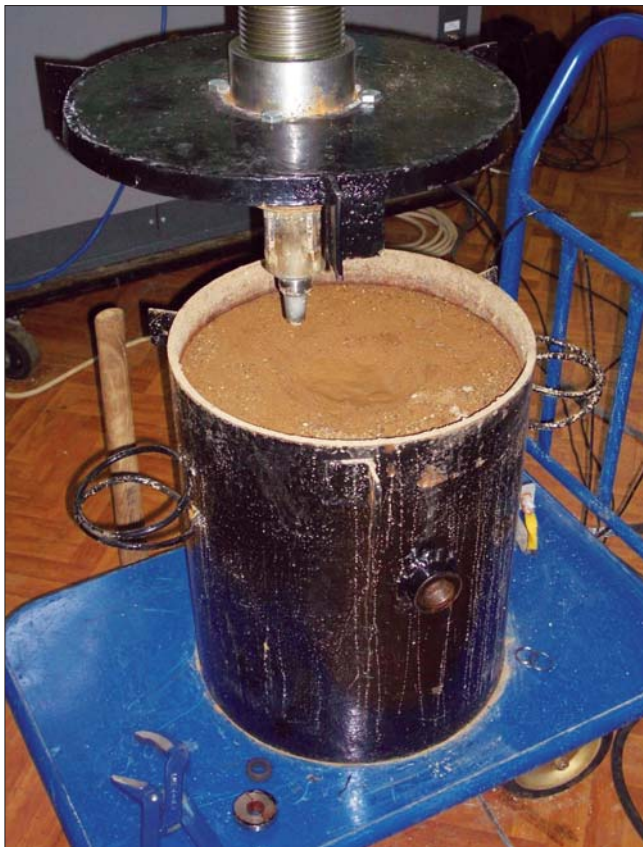
Рис. 3. Опытный лоток, заполненный водонасыщенным песком
