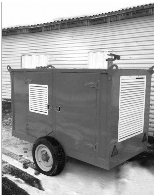
Рис. 2. Силовая гидравлическая станция на основе дизельного двигателя
