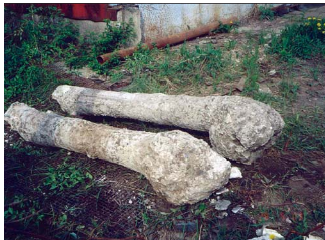
Рис. 6. Уширение буринъекционной сваи (режим ЭХВ) в глинистом грунте
