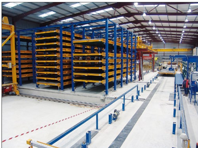
Рис. 5. Общий вид запускаемой в производство технологической линии опалубочных паллет для производства изделий КПД в Томске
