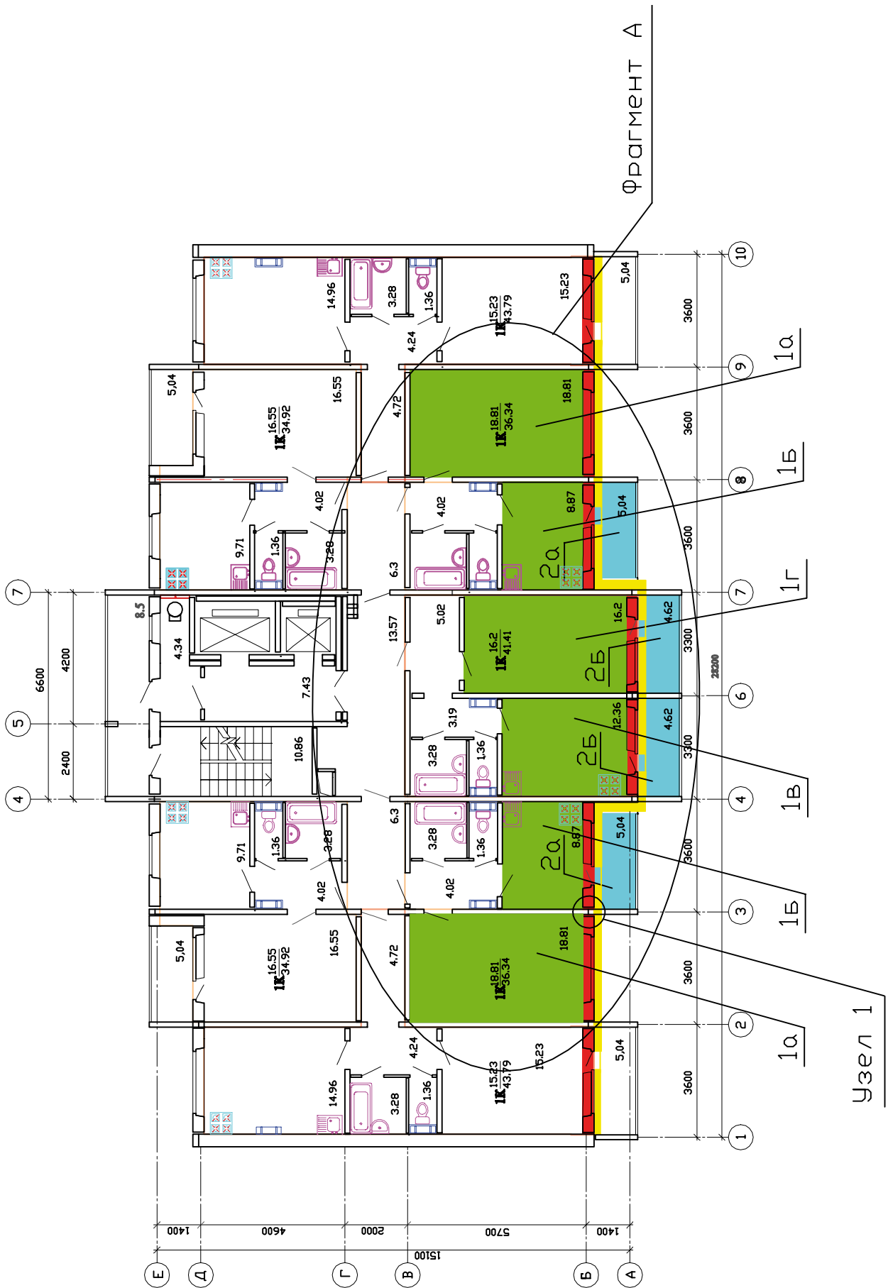
Рис. 1. Базовая блок-секция Казанского завода КПД-3
