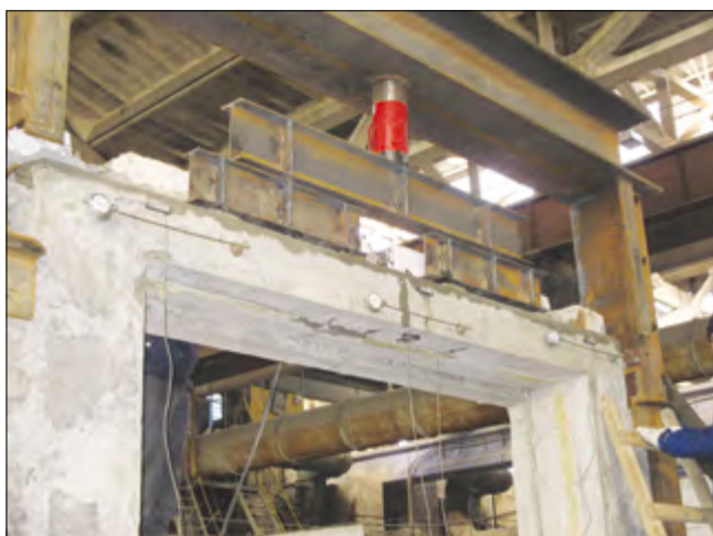
Рис. 5. Испытание перемычечной части с помощью гидравлики
