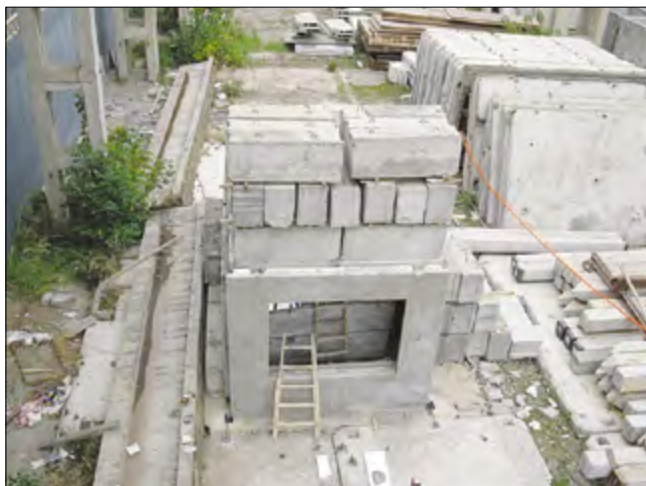
Рис. 3. Испытание перемычечной части в составе панельной сборки
