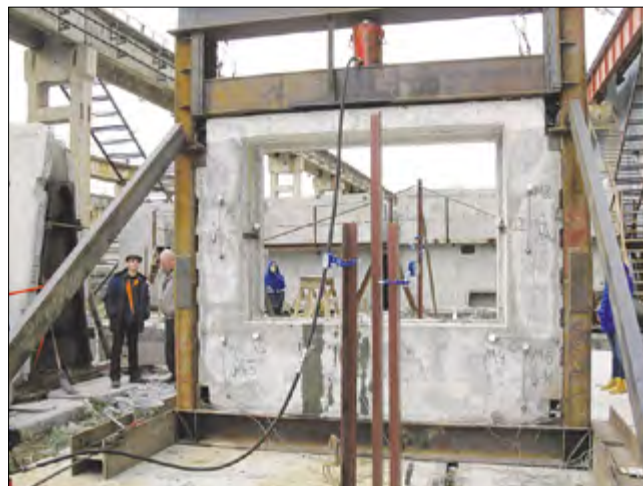
Рис. 4. Испытание простеночных частей
