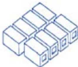
Рис. 3. Объемно-блочная схема со сдвижкой по продольной оси
