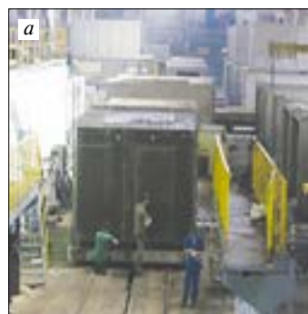
Рис. 15. Этапы подготовки и сборки поддона с сердечником: а – сердечник на посту подготовки; б – сердечник на посту армирования; в – передача сердечника в формовочную машину; г – пост очистки и смазки сердечника
