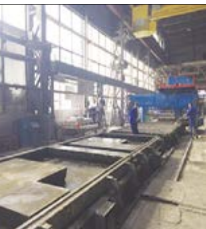
Рис. 21. Конвейерная линия производства стеновой панели
