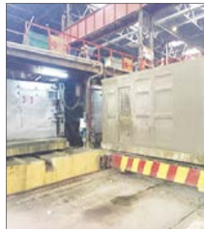
Рис. 17. Передача блока с сердечником на пост вторичной термообработки
