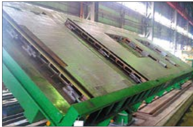
Рис. 9. Отформованные трехслойные наружные стеновые панели на поворотных столах
