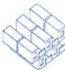
Рис. 4. Панельно-блочная схема с шахматным расположением блоков по вертикали
