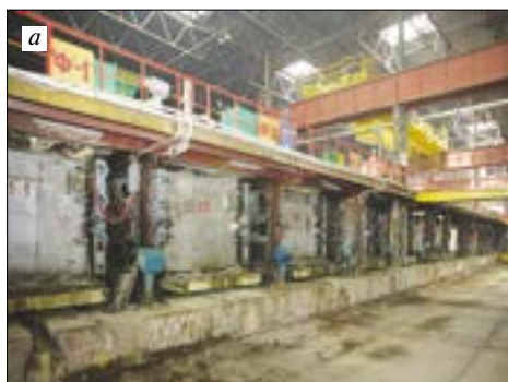
Рис. 14. Формовочная машина объемных блоков: а – общий вид; б – схема
