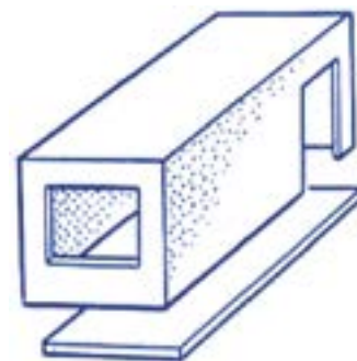
Рис. 12. Блок типа «колпак». Монолитно связанные четыре стены с потолком, но без пола
