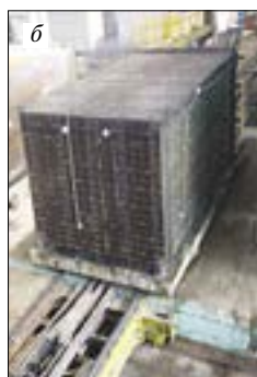
Рис. 15. Этапы подготовки и сборки поддона с сердечником: а – сердечник на посту подготовки; б – сердечник на посту армирования; в – передача сердечника в формовочную машину; г – пост очистки и смазки сердечника
