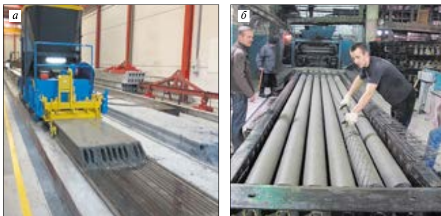
Рис. 1. Формование многопустотных плит: а – безопалубочное формование; б – формование на стендах
