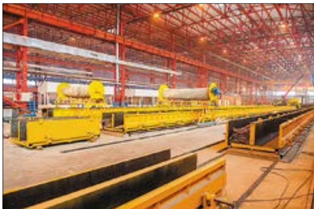
Рис. 8. Цех производства длинномерных изделий РКД «Иркутский каркас» (колонны, ригели, сваи и т. п.)
