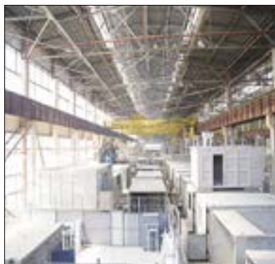
Рис. 10. Блок типа «лежащий стакан». Монолитно связанные три внутренние стены с полом и потолком, но без наружной стены
