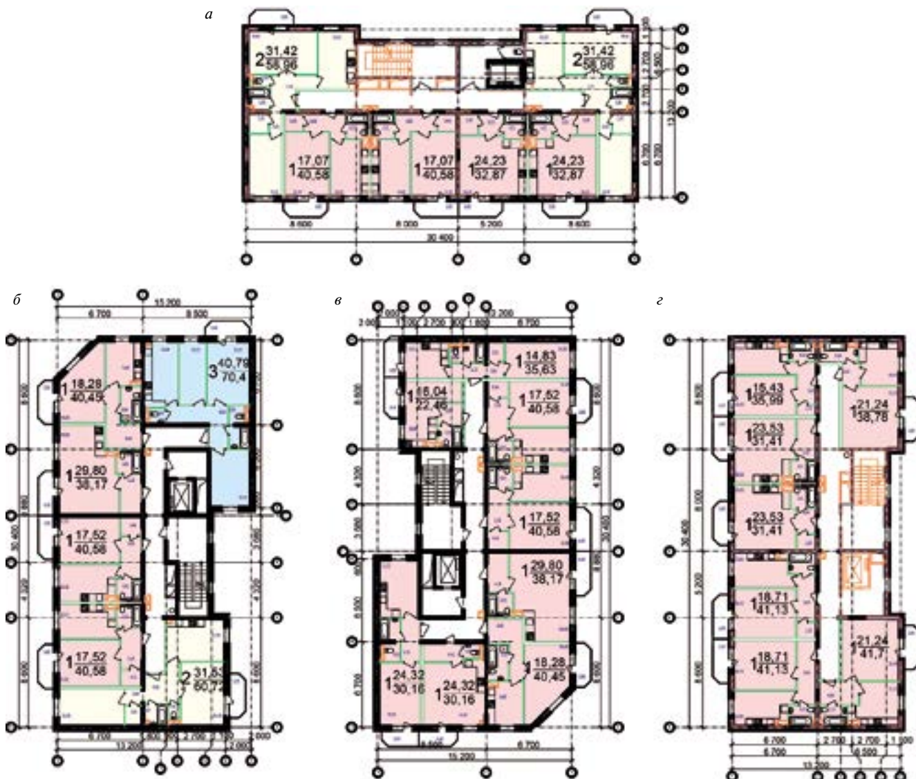
Рис. 3. Блок-секции от 3-х до 9 этажей: а – рядовая широтной ориентации; б – угловая универсальная; в – угловая меридиональной ориентации; г – рядовая меридиональной ориентации
