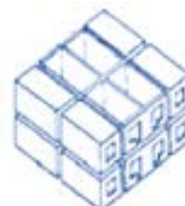
Рис. 5. Панельно-блочная схема с включением панелей на комнату
