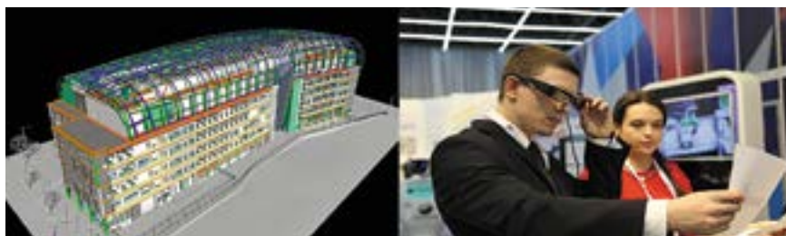
Рис. 3. Интерактивная модель проекта производства работ скоростного возведения зданий из модульных систем (слева) и средства виртуальной реальности (справа)
