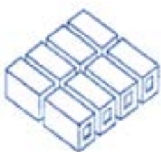
Рис. 2. Объемно-блочная конструктивная схема здания
