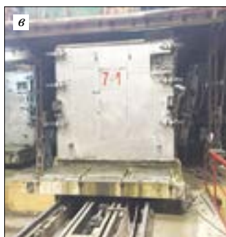
Рис. 15. Этапы подготовки и сборки поддона с сердечником: а – сердечник на посту подготовки; б – сердечник на посту армирования; в – передача сердечника в формовочную машину; г – пост очистки и смазки сердечника
