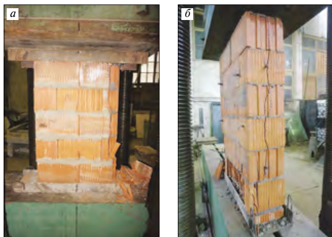
Рис. 6. Характер разрушения образцов II серии без армирования (а) и с армированием сеткой (б)
