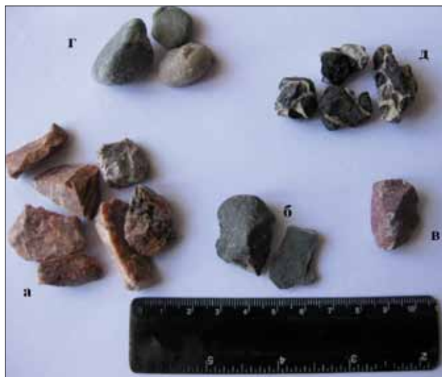
Рис. 5. Зерна минерального заполнителя в составе вторичного щебня (материал одной пробы): а – гранит; б – габбро-диабаз; в – кварцит; г – гнейс; д – металлургический шлак
