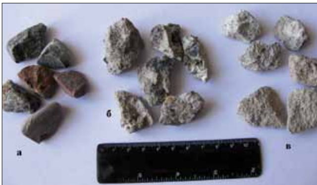
Рис. 4. Компонентный состав вторичного щебня (фракция 20–40 мм): а – раскрытые зерна щебня; б – сростки щебня с цементно-песчаным камнем; в – цементно-песчаный камень
