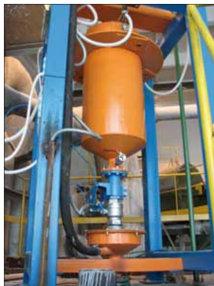
Рис. 4. Система дозирования воды и химических добавок
