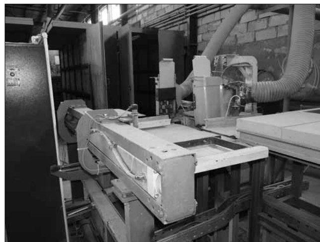
Рис. 2. Установка фрезерования ШЛ 445Б
