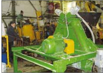
Рис. 4. Внедренный на предприятие по производству неавтоклавного пенобетона дезинтегратор «ГОРИЗОНТ-3000 МК-ВА» (Новгородская обл.)
