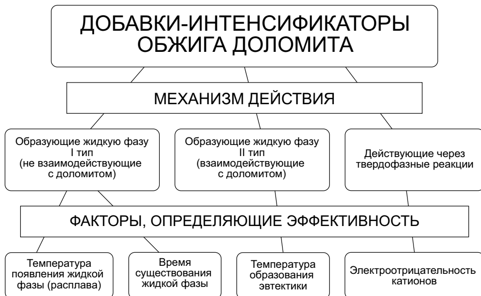
Рис. 11. Классификация добавок-интенсификаторов для обжига доломита
