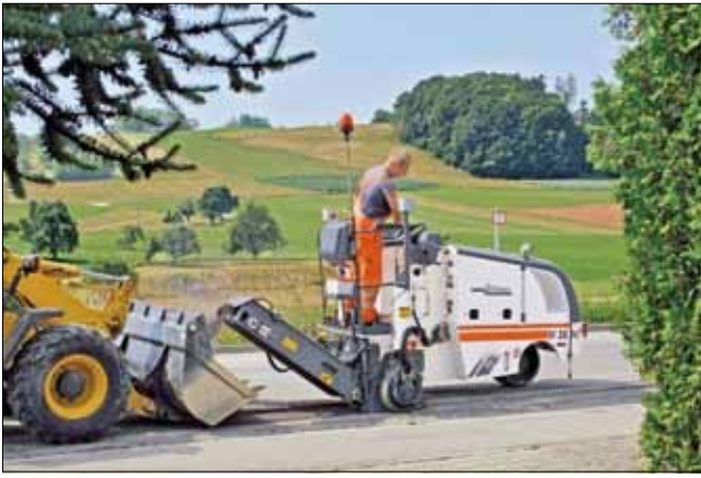
Рис. 3. Холодная фреза W 35 DC, Виртген (Германия)
