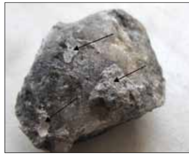
Рис. 8. Цементный раствор (указан стрелками) на поверхности зерна щебня
