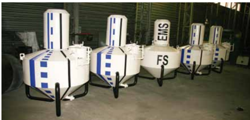
Рис. 1. Смесители для подготовки массы пенобетона СПБУ-1000-ЛЮКС производства ООО «Экостройматериалы»
