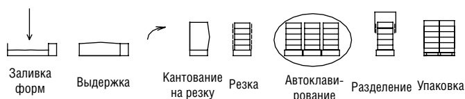
Рис. 1. Схема процесса производства по системе Итонг
