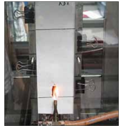
Рис. 3. Установка для испытаний по методу ГОСТ Р «Материалы строительные. Метод испытаний на возгораемость под воздействием малого пламени» («малая горелка»). Определяемые показатели: воспламенение фильтровальной бумаги горящим расплавом или частицами образца; наличие распространения пламени на расстояние 150 мм от точки его воздействия в течение 20 и 60 с
