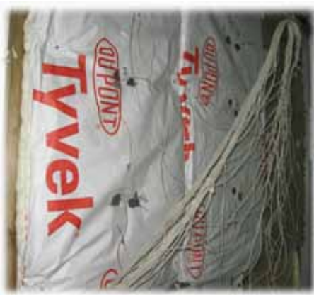
Рис. 2. Фрагмент фасада, собранного в климатической камере с установленными датчиками
