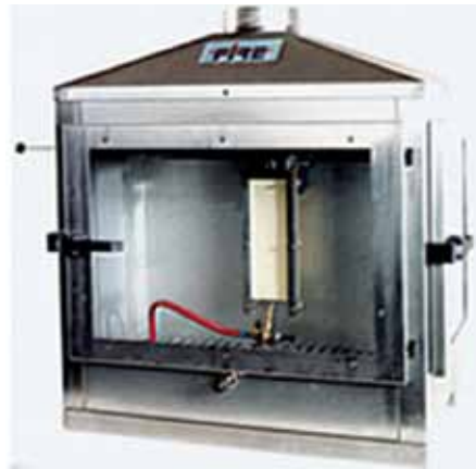
Рис. 3. Установка для испытаний по методу ГОСТ Р «Материалы строительные. Метод испытаний на возгораемость под воздействием малого пламени» («малая горелка»). Определяемые показатели: воспламенение фильтровальной бумаги горящим расплавом или частицами образца; наличие распространения пламени на расстояние 150 мм от точки его воздействия в течение 20 и 60 с
