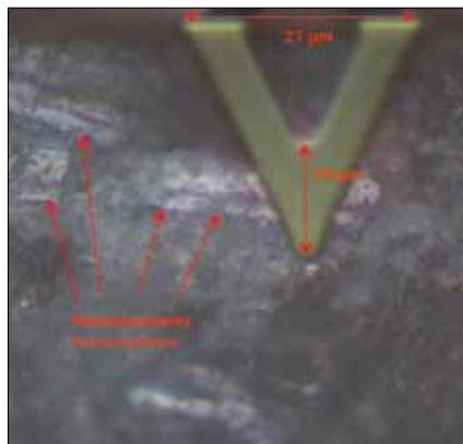
Рис. 8. Оптическое изображение неполированного образца С3. V-образная структура в верхней части рисунка – это кантилевер, на котором установлен наконечник, сканирующий поверхность
