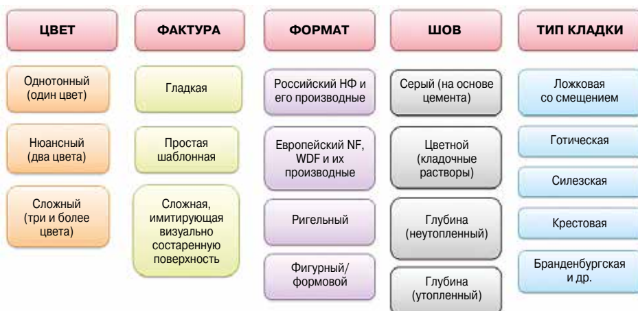
Рис. 1. Основные составляющие элементы кирпичной кладки Fig. 1. The main constituent elements of brickwork
