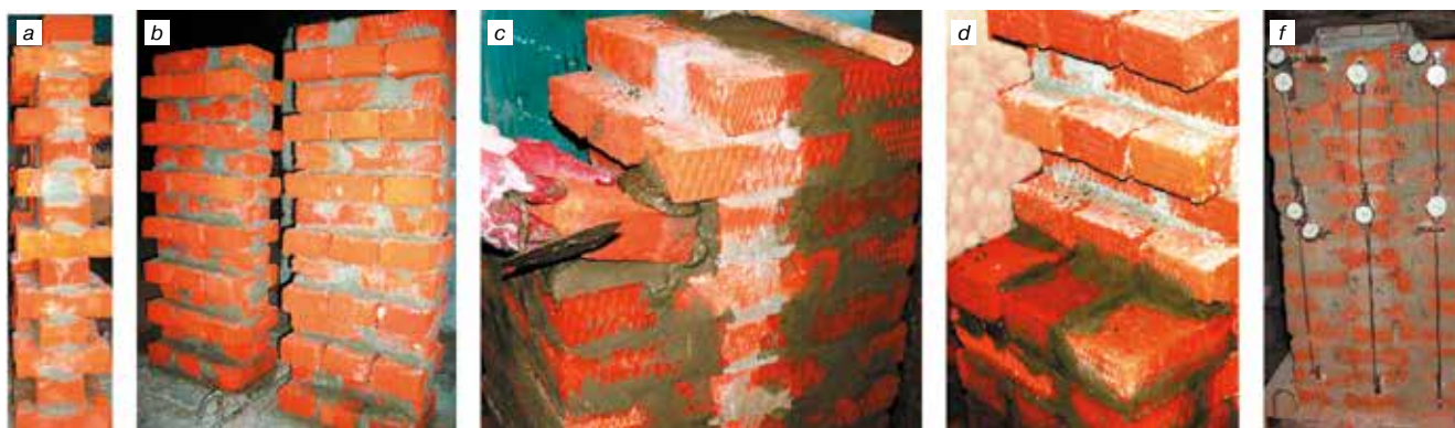
Рис. 4. Испытание кладки обычного и плохого качества на местное сжатие [9]: a, b, c, d – изготовление столба с имитацией ремонта с вычинкой; f – образец во время испытаний на местное сжатие Fig. 4. Test of normal and poor quality masonry for local compression [9]: a, b, c, d – making a pillar with an imitation of repair with a wedge; f – sample during local compression tests
