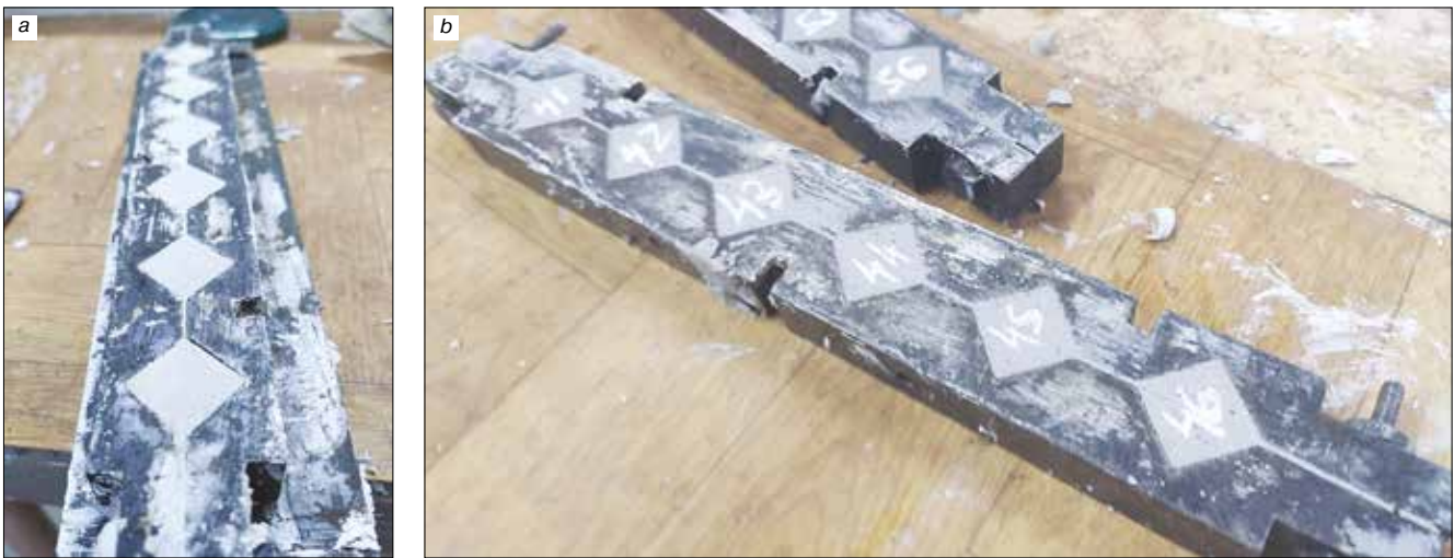
Рис. 2. Формование образцов: a – на основе модифицированного гипсового вяжущего и исходного базальтового отхода (без помола); b – на основе модифицированного гипсового вяжущего и базальтового отхода, активированного в планетарной мельнице
