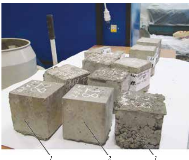
Рис. 1. Бетонные образцы: 1, 2 – с гомогенной структурой; 3 – с явно выраженной сегрегацией компонентов
