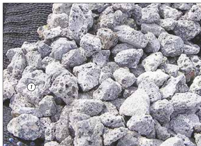
Рис. 1. Кубовидная форма литого шлакового щебня: 1 – открытые поверхностные поры шлакового заполнителя
