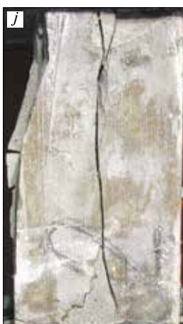
Рис. 8. Интерферограммы (a–c, e, g–i), 3D-графики (d, f) деформаций поверхности и фотография (j) образца состава № 5 ( \Delta\sigma=1,53 МПа, другие пояснения приведены в тексте)
