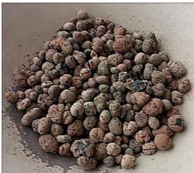
Рис. 4. Облегченный керамзитовый гравий фракции 20–40 мм (марка по насыпной плотности M250) производства ООО «Уфимская гипсовая компания». Fig. 4. Lightweight expanded clay gravel fractions of 20–40 mm (grades with a bulk density of M250) manufactured by Ufa Gypsum Company
