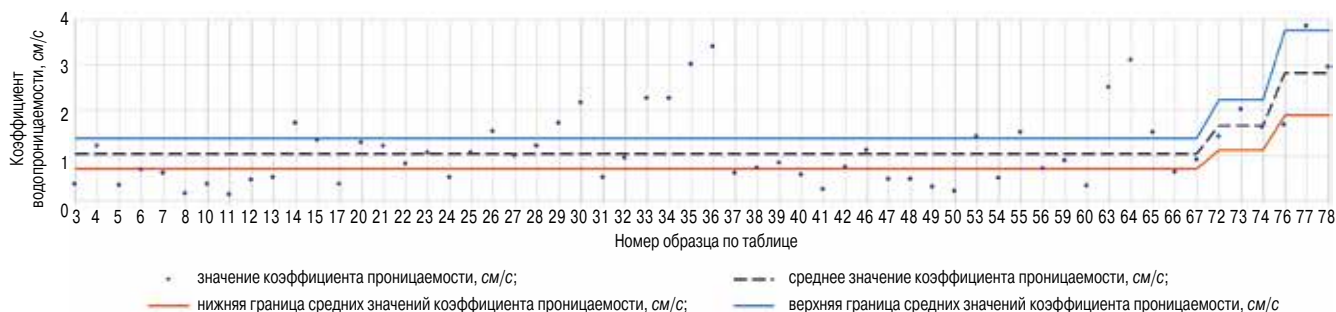
Рис. 6. Коэффициент водопроницаемости образцов высокопроницаемого бетона Fig. 6. Water permeability coefficient of highly permeable concrete samples
