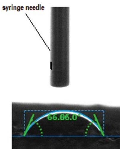
Рис. 4. Капля дистиллированной воды, сформированная на поверхности мелкозернистого бетона
