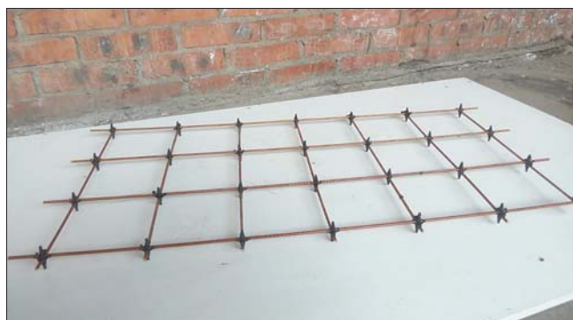
Рис. 6. Композитная сетка для фасадного слоя Fig. 6. Composite mesh for the facade layer
