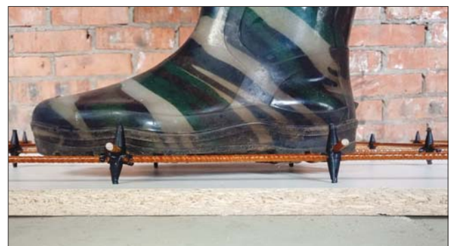
Рис. 7. Композитная сетка для фасадного слоя под весом взрослого человека Fig. 7. Composite mesh for the facade layer under the weight of an adult
