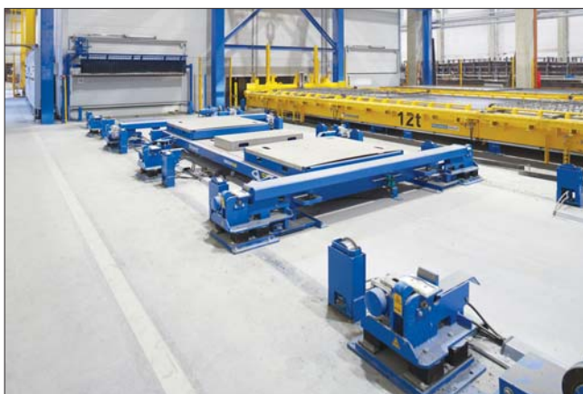
Для уплотнения свежесобетонированных элементов на заводе НТВ используются установка горизонтального уплотнения и комбинированная установка уплотнения
