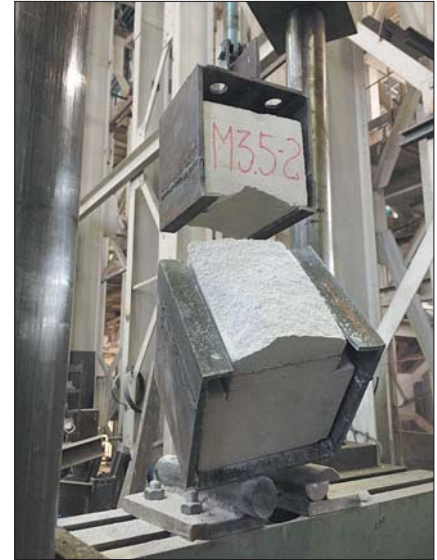
Рис. 6. Характер разрушения образцов, изготовленных на пенополиуретановых клеях Fig. 6. Character of destruction of samples made on polyurethane foam adhesives
