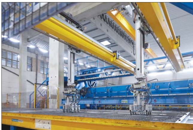
Производство арматуры на новом заводе по производству двойных стеновых панелей и филигранных/сборных перекрытий в г. Кеннерн также максимально автоматизировано. Робот-укладчик Wire Center устанавливает на паллеты с опалубкой продольные и поперечные арматурные прутки, а также треугольные арматурные каркасы/фермы с помощью двух манипуляторов
