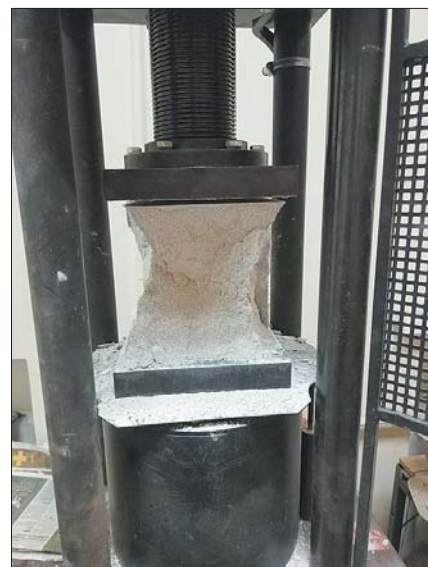
Рис. 3. Образец из ячеистого бетона после испытания при сжатии Fig. 3. Aerated concrete cubes samples after compression test
