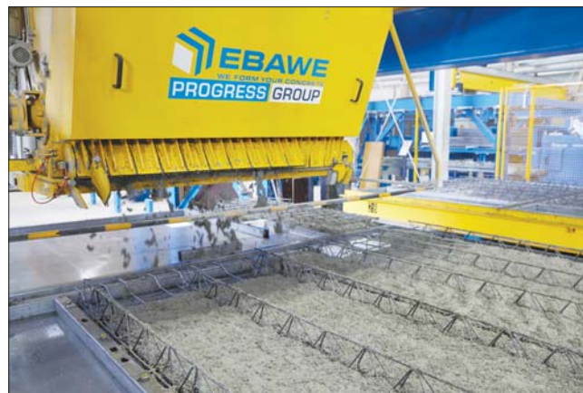
Новый бетонораздатчик Ebaawe выполняет процесс бетонирования филигранных/сборных перекрытий и двойных стеновых элементов в полностью автоматическом режиме
