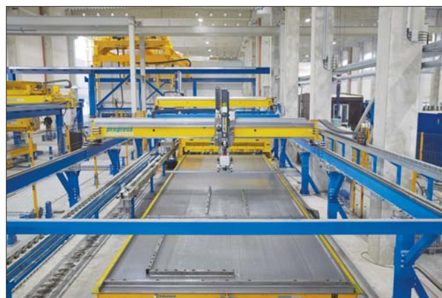
Комбинированный робот укладки и снятия опалубки компании progress Maschinen & Automation работает с системой опалубки Infinity Line® , которая значительно снижает затраты по работе с опалубкой и позволяет изготавливать внешние кромки очень высокого качества
