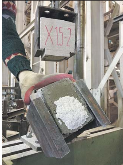
Рис. 5. Характер разрушения образцов, изготовленных на цементном растворе Fig. 5. Character of destruction of samples made on cement mortar
