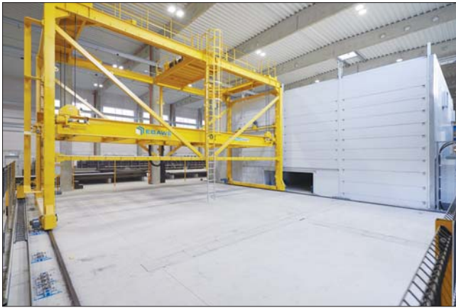
Штабельный слеллаж вмещает 36 паллет и обслуживается подъемно-передаточной платформой
