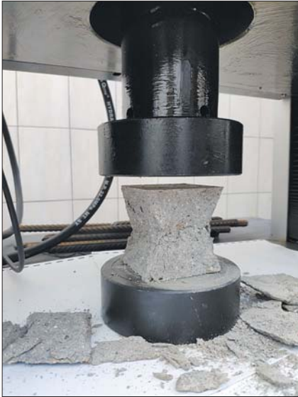
Рис. 4. Образец из кладочного раствора после испытания при сжатии Fig. 4. Samples of cubes from masonry mortar after compression test
