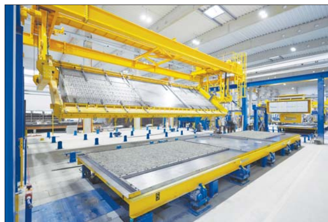
Для производства двойных стеновых панелей затвердевшую первую скорлупу переворачивают и укладывают поверх свежесобетонированной второй скорлупы. Этот процесс осуществляется с помощью автоматического переворачивающего устройства
